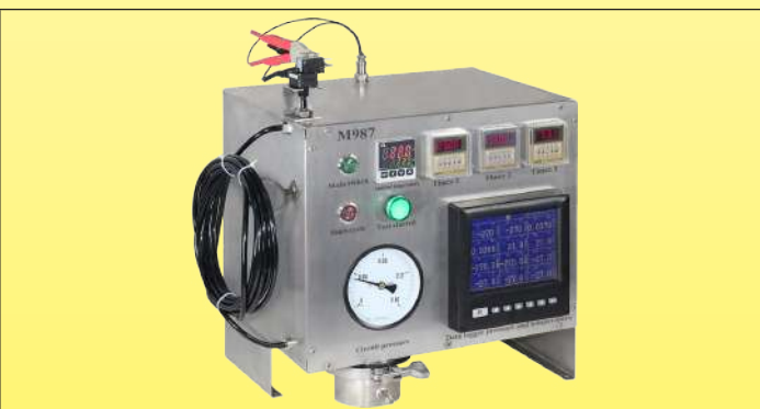
Испытательное оборудование для многократного и постоянного измерения максимальной длины соединительных трубок воздушного выключателя в зависимости от объема кнопки и развиваемого ею давления (лаборатория Ultimheat)
